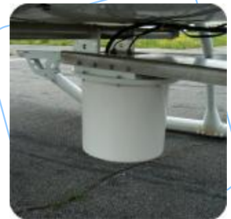
Pod avec antenne et GPS intégré
