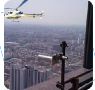
Matériel d'émission sur hélicoptère et antennes de réception «Diversity» sur un toit d'immeuble.
